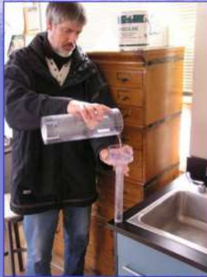
Pour snow sample into smaller tube
